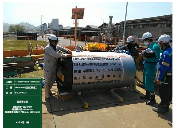
φ 900mmミリングモール掘進機
