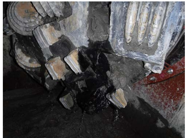
No.2 到達後 切削ビット摩耗状況
