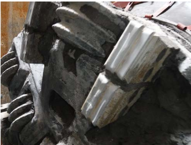
No.2 到達後 切削ビット摩耗状況
