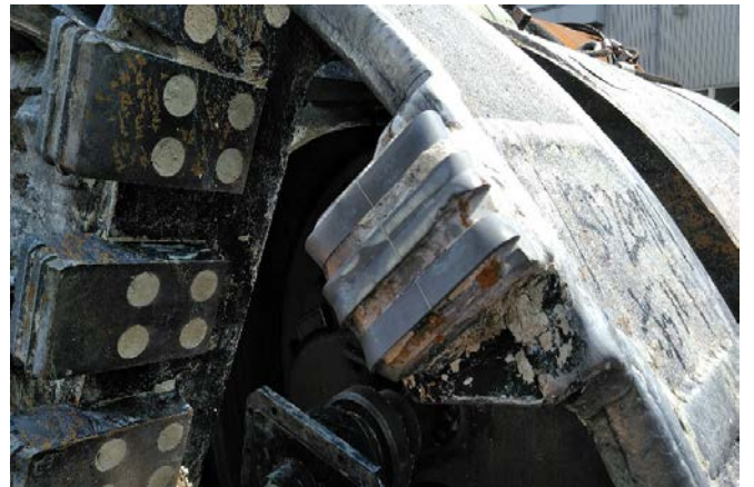
推進完了後カッタービット
