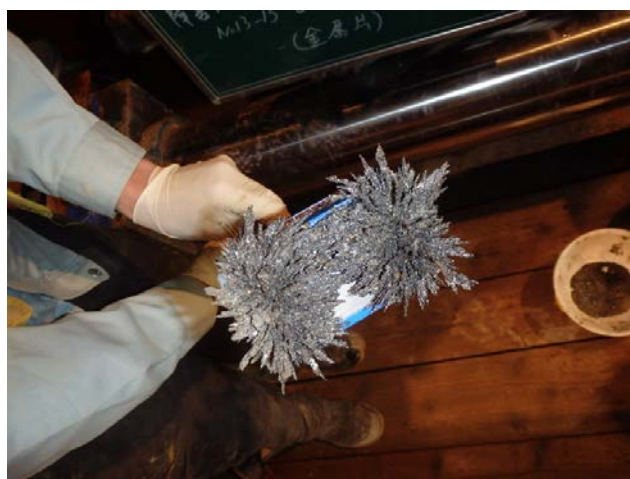
障害物切削 切削片確認(金属片)
