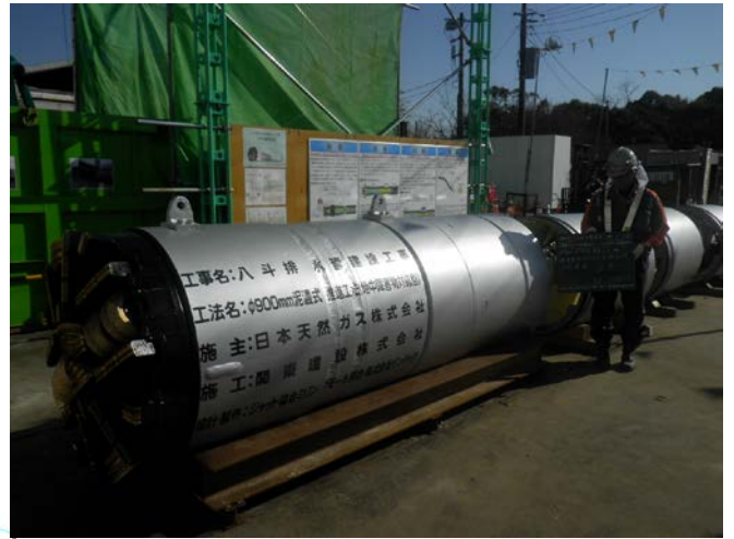
φ900mm ミリングモール掘進機
