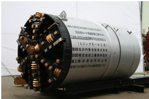
\phi 2000mm ミリングモール掘進機
