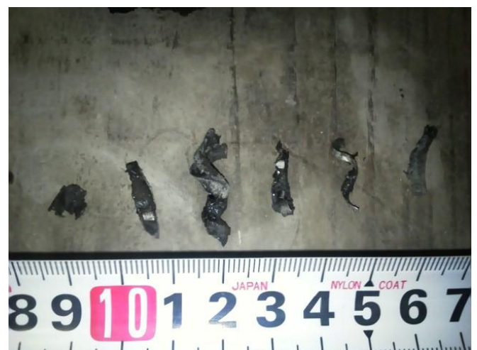
排出した金属片。およそ 1cm 程度に切削
