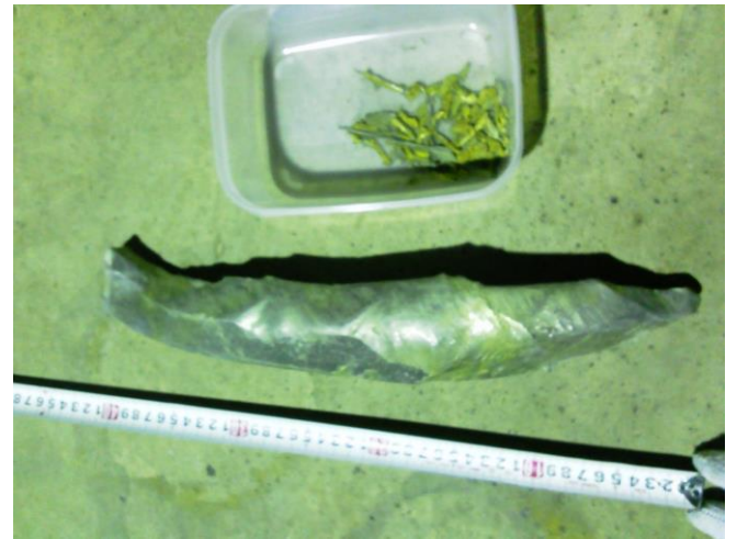
最初に排出した金属片。かなり大きな状態で切削。
