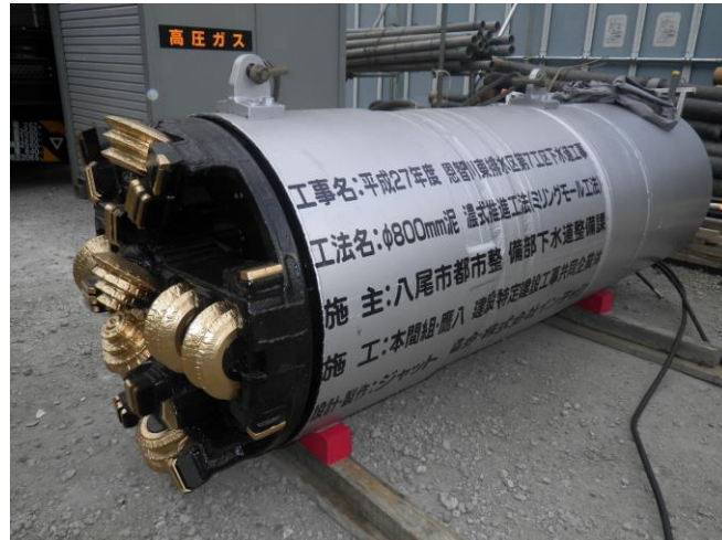
φ 800mm ミリングモール掘進機
