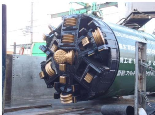
$\phi 1000\text{mm}$  ミリングモール掘進機
