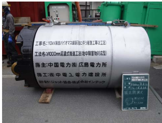
φ1000mmミリングモール掘進機
