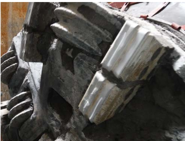
No.2 到達後 切削ビット摩耗状況
