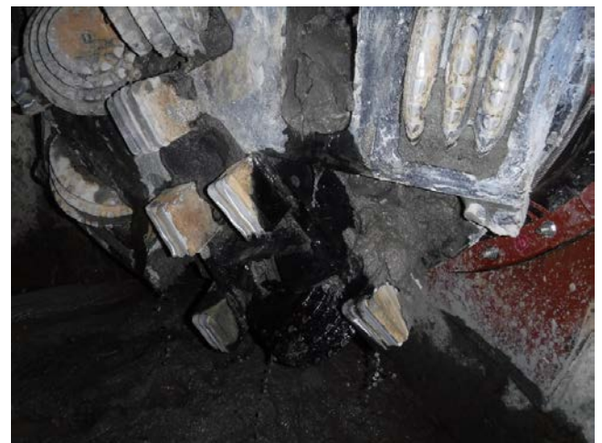
No.2 到達後 切削ビット摩耗状況
