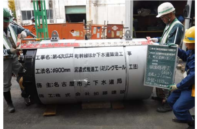
φ 900mmミリングモール掘進機
