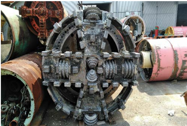
推進完了後カッタービット
