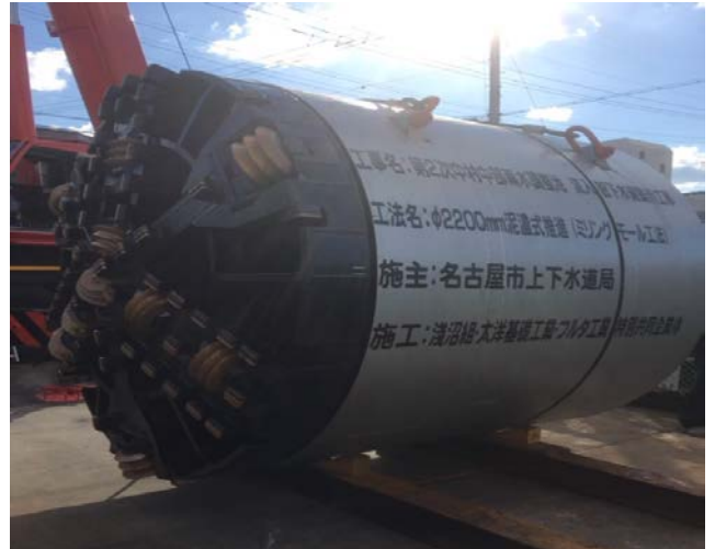
φ 2200mmミリングモール掘進機
