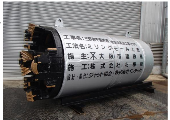
\phi 800mm ミリングモール掘進機
