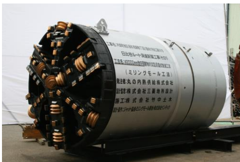
φ 2000mm ミリングモール掘進機
