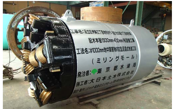
φ 1000mm ミリングモール掘進機
