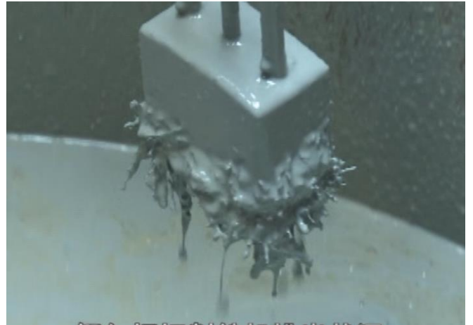
2012.02.03 真空排泥タンク内へ磁石を投入し引き上げた状態写真 排出された泥土内から切削した金属粉の付着を確認
