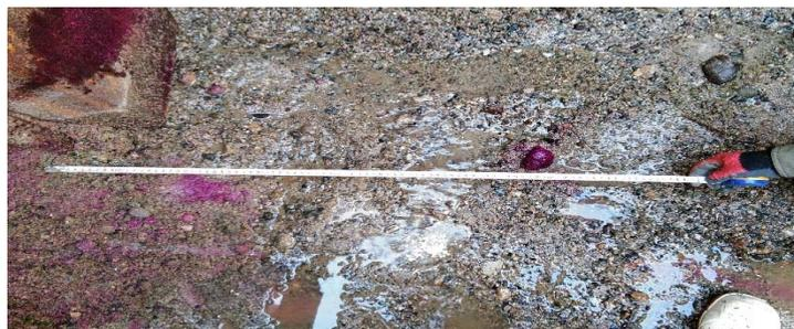
写7. 機内注入工法改良範囲検尺④
