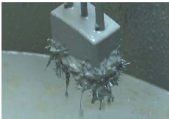
2012.02.03(岸和田市)鋼矢板Ⅲ型6か所切削 真空排泥タンク内へ磁石を投入し引き上げた 状態写真 排出された泥土内から切削した金属粉の付着 を確認
