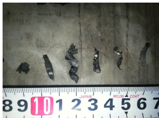
2013.01.13(東京西新橋)H型鋼(300) 4箇所切削 磁石に吸着させ取り出した切削金属単体 写真
