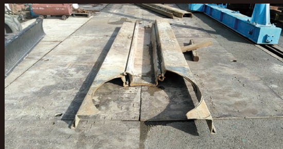
2018切削実験で切削貫通鋼矢板Ⅲ型
